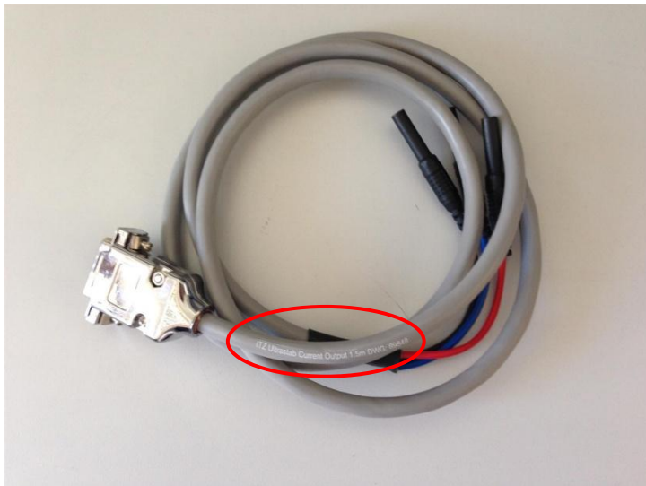
D-SUB-Leitung „ITZ ULTRASTAB CURRENT OUTPUT“ für Stromausgang
