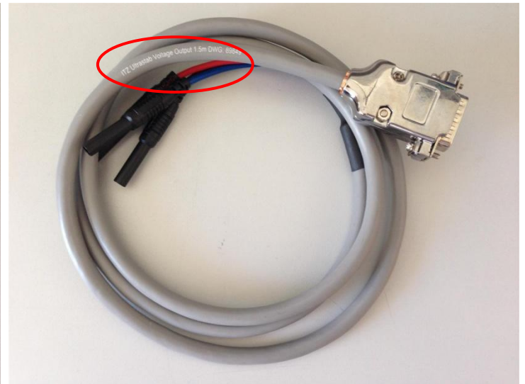
D-SUB-Leitung „ITZ ULTRASTAB VOLTAGE OUTPUT“ für Spannungsausgang
