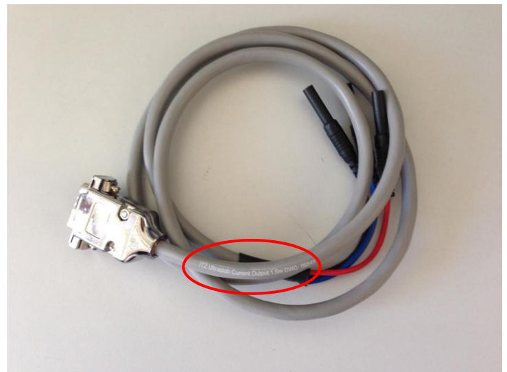
D-SUB-Leitung „ITZ ULTRASTAB CURRENT OUTPUT“ für Stromausgang
